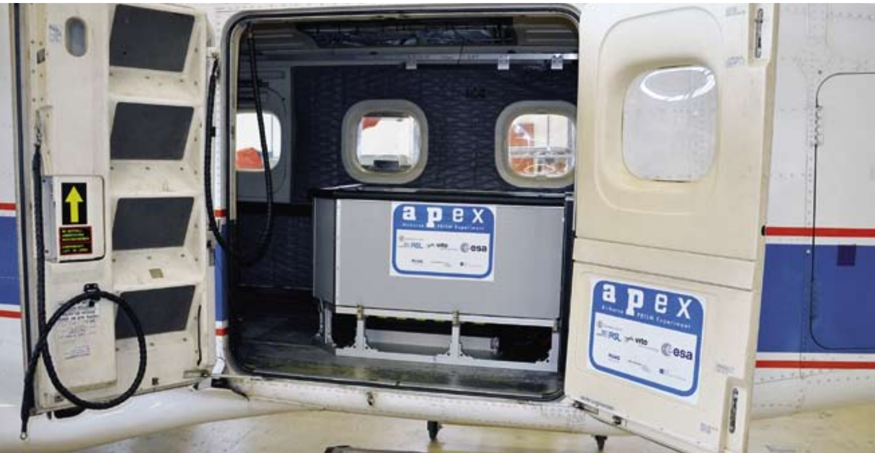
Vielfältig einsetzbar: APEX ermittelt die Vegetationsdichte, aber auch den Zustand von Ziegeldächern und Strassenbelägen.
