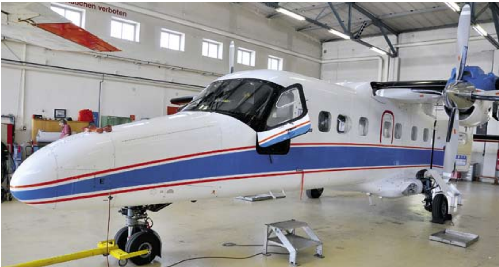
Die Dornier DO-228 bringt das APEX-Spektrometer auf 3500 Meter über Grund.
